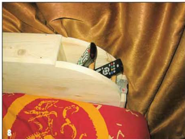
8 ...для пультов. Опорами для последних служат цилиндрические деревянные перемычки, установленные между стенками короба изголовья.
