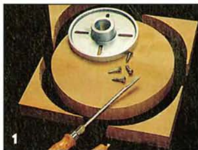
1 Круглую заготовку вырезают электролобзиком из квадратной плиты. В центре заготовки привинчивают планшайбу.
