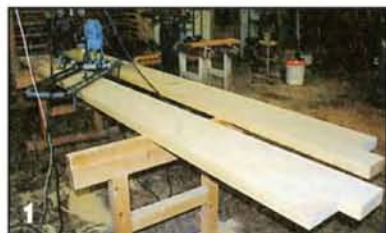
1 Узкие строганные доски попарно сплачивают, получая заготовки для тетив.
