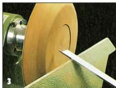
3 Углубление на тыльной стороне блюда вытачивают косой плоской токарной стамеской. Это углубление позволит потом точно закрепить заготовку на разжимном патроне станка.
