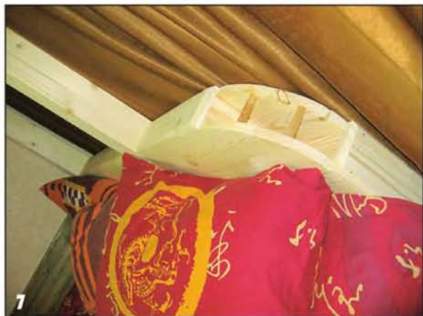
7 Верхний выступающий угол коробчатого изголовья скруглили, соорудив в нём небольшую открытую полочку...
