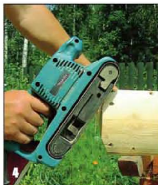
Собранный короб тщательно отшлифовали, придав наружным поверхностям ровную округлую форму.
