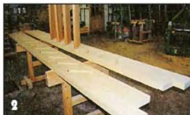
2 В заготовках для тетив выбирают пазы, в которые временно, чтобы проверить подгонку, вставляют ступеньки.
